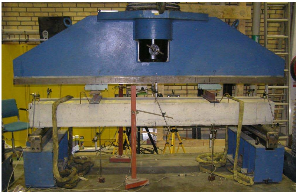
Figur 2. Provuppställning för fullskaleförsök.
